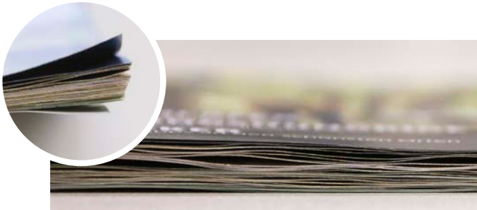
Typisches Auswachsen des Inhaltes um einen Millimeter an der Außenseite des Umschlags
